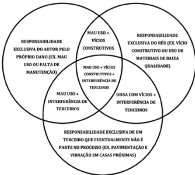
Figura 17 – A concorrência de fatores para as anomalias em um imóvel. Fonte: teixeiracosta.com.br/patologia-da-construcao
