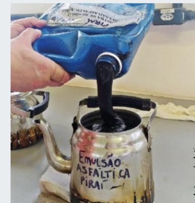
Figura 1 - Retirada da emulsão asfáltica envelhecida do galão de coleta
