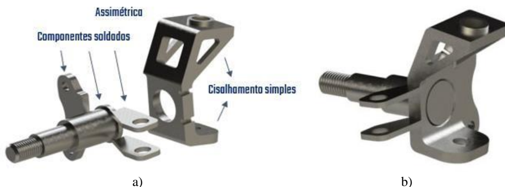
Figura 8 – Manga de eixo SB-19. a) Vista explodida – Montagem da manga de eixo. b) Vista isométrica – Montagem da manga de eixo.
