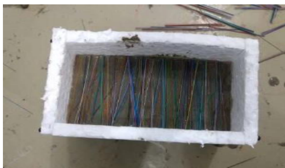
Figura 4: Fibras óticas de vidro distribuídas no protótipo com a argamassa (FREITAS; CASSOL, 2018)
