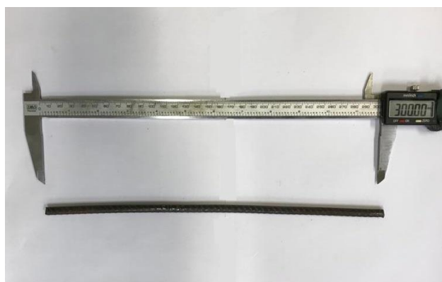
Figura 2 – Vergalhão de aço CA-60 com diâmetro nominal de 7 mm e 30 cm de comprimento
