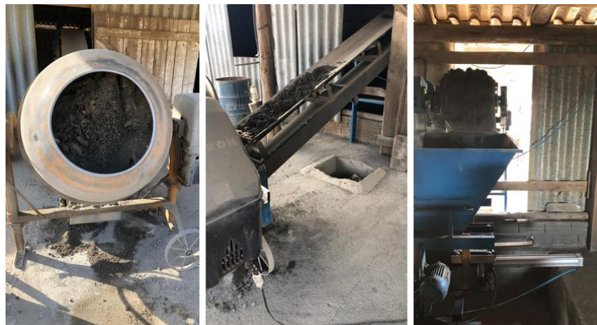
Figura 3 - Homogeneização e abastecimento do silo da Máquina vibro-prensa. Fonte: Do autor (2020)
