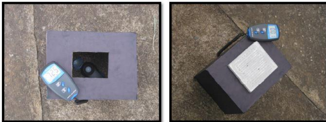
Figura 5: Caixa preta com o luxímetro e o painel de concreto translúcido (RESTREPO, 2013)
