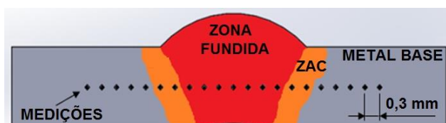
Figura 3 – Esquema de obtenção dos perfis de microdureza
