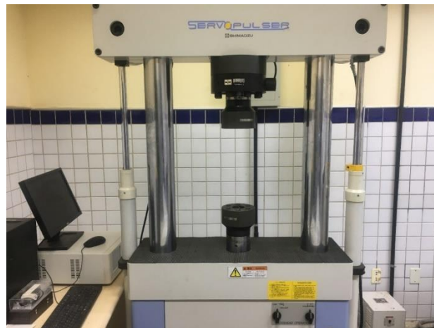
Figura 4 – Máquina Shimadzu Servo Pulser modelo EHF-EV200K1-010-0A
